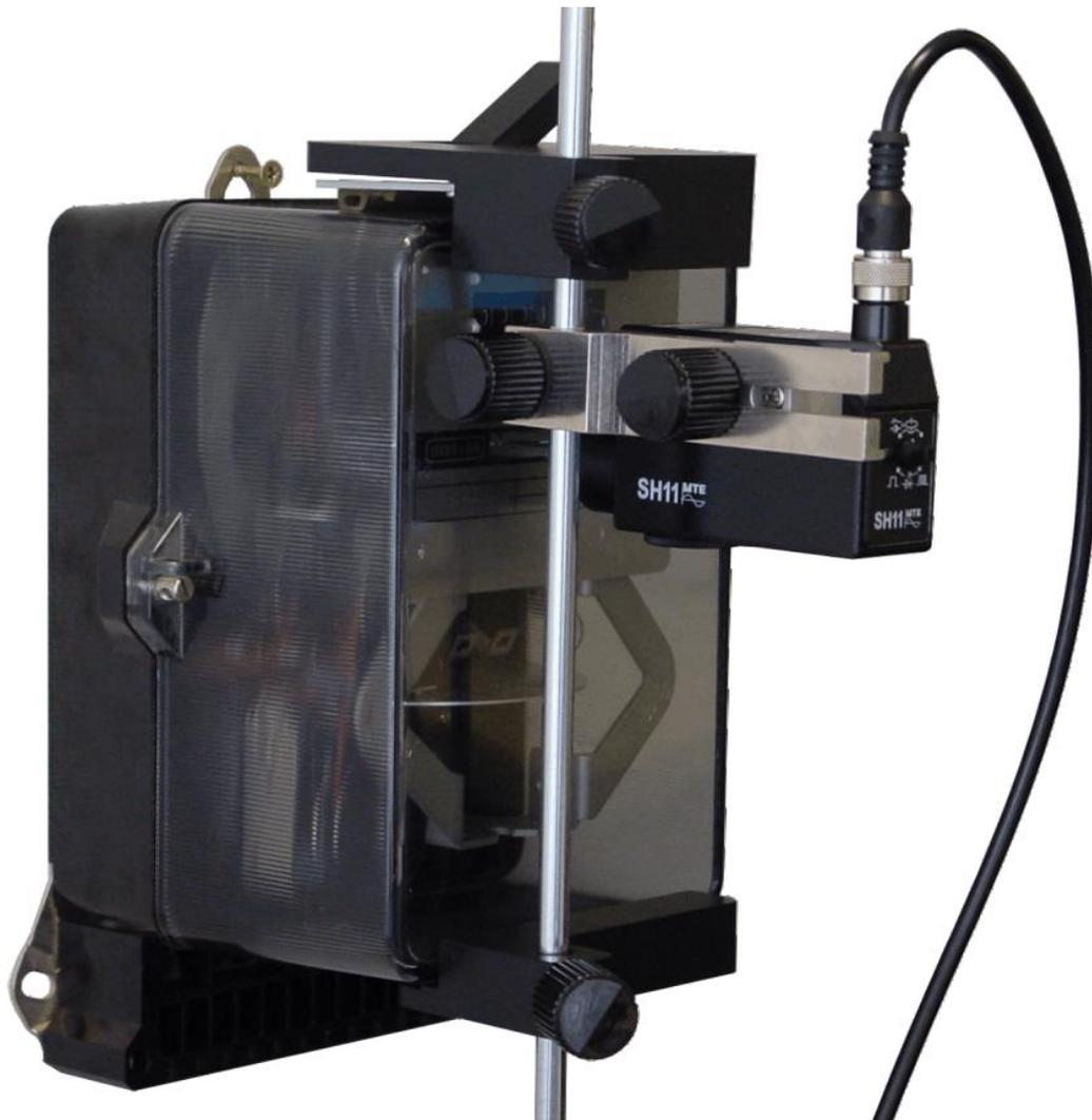
Die Abtasthalterung TVU 7.2 wurde für die Vorort-Prüfung von Zähler mit dem fotoelektrischen Tastkopf SH 11 entwickelt.
